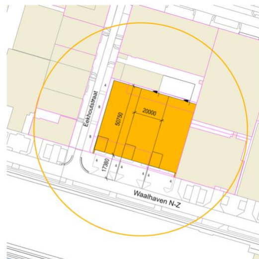
VARIANT 2 voorgevel in de rooilijn hallen ca. 50,75m diep
